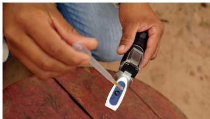
Muestra de miel en refractómetro, dispositivo para analizar la humedad
